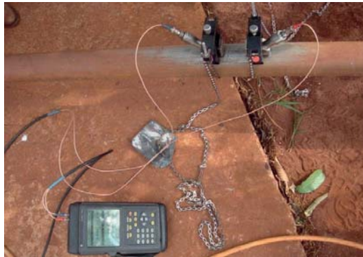
Figura 90: Estação Pitométrica – Ponto de medição 14.
