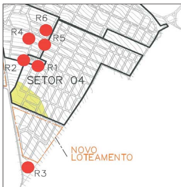
Figura 115: Delimitação de áreas com pressões críticas – Setor 04.
