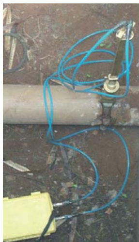
Figura 59: Estação Pitométrica – Ponto de medição 1.
