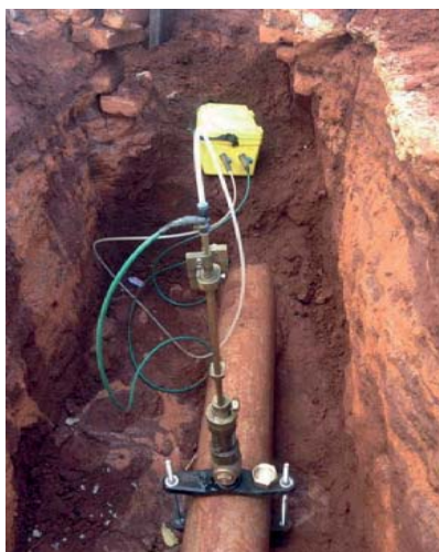
Figura 76: Estação Pitométrica – Ponto de medição 6.
