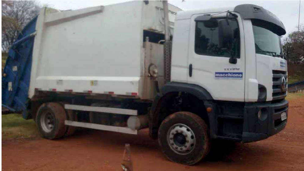
Figura 4.5.11 – Caminhão com caçamba compactadora (Coleta domiciliar e comercial)
