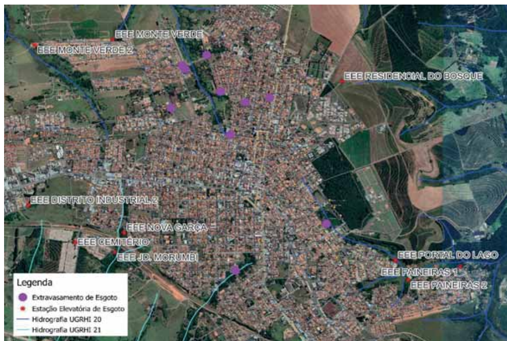
Figura 4.2.59 – Pontos de extravasamento de rede de esgoto no município de Garça
