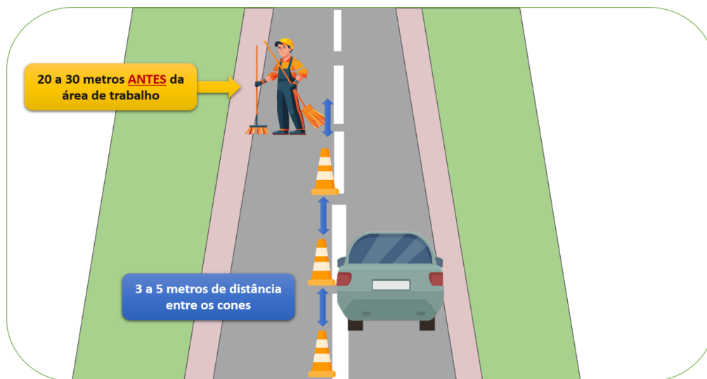
Figura 54. Orientações básicas para o uso dos cones de sinalização recomendadas para a varrição pública das vias
